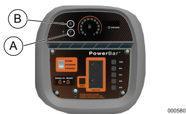
Figure 3-3. Problème entraînant l'arrêt de l'appareil
